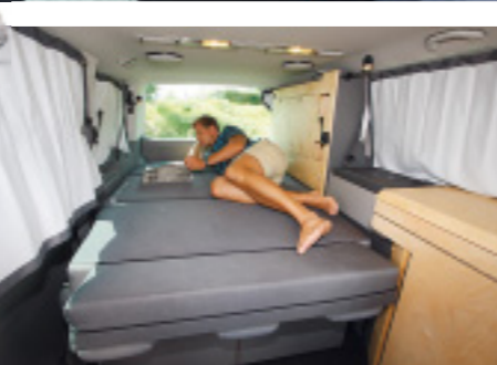
Genial: stabiler Schwenktisch als Schranktür, herausnehmbare, lange Schlafbank und LED-Leuchten im Seriendachhimmel (ohne Klappdach).
